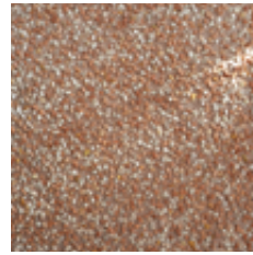
IT Deco Ghiaino: duna Cemento: bianco Graniglia: spaccato 9-12 mm 50% bianco Verona + 40% rosso Verona + 10% giallo Siena EN Cement: white Aggregates: broken 9-12 mm
