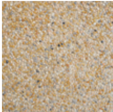
IT Deco Ghiaino: giallo ocre Cemento: bianco + grigio Graniglia: ciottolo 9-12 mm 45% giallo mori + 45% rosa corallo + 10% grigio carnico EN Cement: white + gray Aggregates: round 9-12 mm
