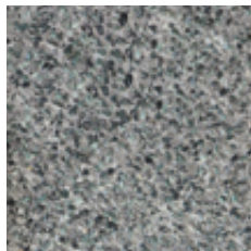
IT Deco Ghiaino: incolore Cemento: grigio Graniglia: spaccato 9-12 mm 100% verde Alpi EN Cement: gray Aggregates: broken 9-12 mm
